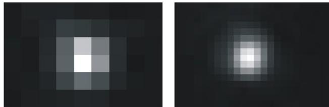
**Abbildung 3.10:** Bild der Lochblende auf der EMCCD-Kamera bei Betrachtung durch die Abbildungsoptik. Die Vergrößerung beträgt  $a = 13.7$  im linken Bild ( $f = 500 \text{ mm}$ ) und  $a = 26.6$  im rechten Bild ( $f = 1000 \text{ mm}$ ).
