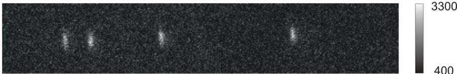
Abbildung 5.4: Vier in der Dipolfalle gefangene Atome bei ständiger Beleuchtung durch die optische Melasse. Rechts sind die Zählraten der Kamera und die Farbabstufungen dargestellt. Die Belichtungszeit beträgt  $500 \text{ ms}$ .
