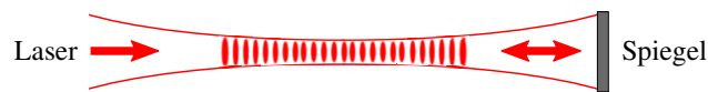
Abb. 2.2: Schematische Darstellung eines optischen Gitters (Dipolfalle). Ein Laserstrahl wird reflektiert und bildet eine stehende Welle. Die Gitterkonstante entspricht der halben Wellenlänge des Lasers.
