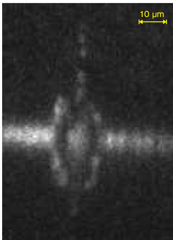
Abbildung 2.10: Die beiden überlagerten Dipolfallen. Abhängig von der lokalen Gesamtfallentiefe kühlt oder heizt die eingeschaltete Melasse. Nur in Regionen mit der passenden Gesamtfallentiefe können die Atome überleben.
